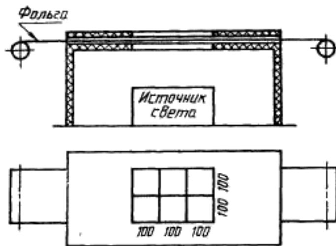
Прибор изготавливается в форме ящика, внутри которого предусматривается достаточное освещение. В верхней части ящика вырезают отверстие прямоугольной формы, в котором устанавливают сетку с клетками площадью 1 дм<sup>2</sup>.
